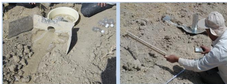
شکل ۲- اندازه گیری سطح مقطع شیار به وسیله شیارمتر (راست) و جمع کننده رواناب (چپ)
