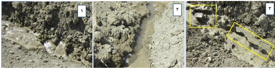
شکل ۶- انتقال رسوب در بازه‌های زمانی ابتدایی (۱)، میانی (۲) و انتهایی (۳) آزمایش
